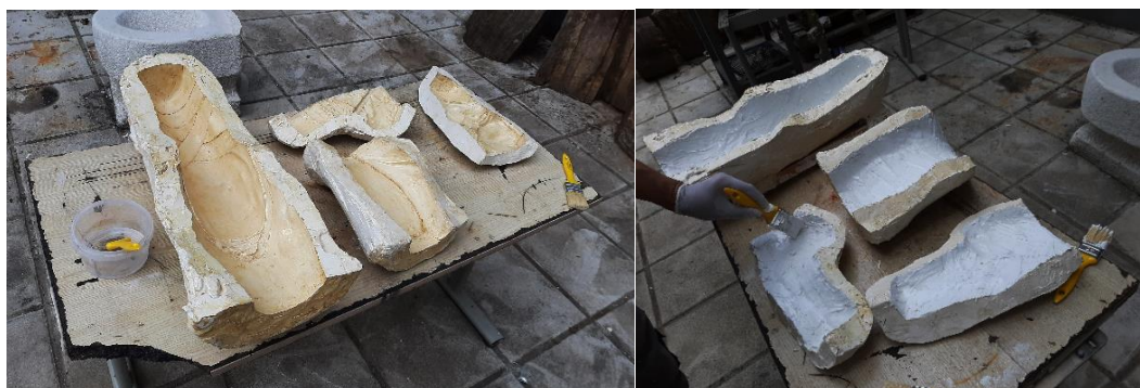
Lijevo: Slika 65: Lucija Savić, kalup premazan 'releasantom', 2024., Desno: Slika 66: Lucija Savić, nanošenje prvog sloja poliester, 2024.
