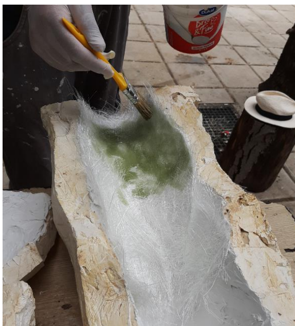
Slika 67: Lucija Savić, nanošenje poliester i staklene vune, 2024.
